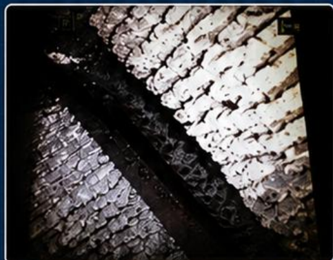
BOROSCOPIA TUBOS LÍNEAS DE INTERIOR DE MAZOS ANTES DE LIMPIEZA
